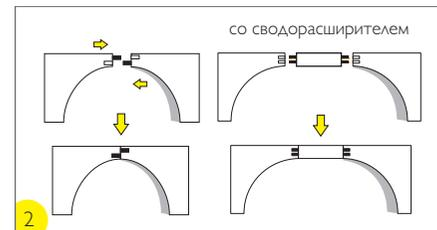
Если вы устанавливаете арку в проем шириной от 100 до 150 см, используйте сводорасширитель. При помощи ножовки отпилите необходимую длину сводорасширителя. Затем, относительно отверстия на сводах, засверлите отверстия в торцевой части сводорасширителя при помощи электродрели. Отверстия должны быть диаметром 6,1 мм и глубиной 15 мм. Установите сводорасширитель с помощью шкантов между деталями свода.
