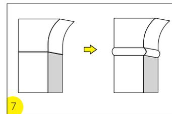
Импост крепится к деталям свода и наличникам, позволяет закрывать стыковочные щели. Измерьте расстояние между наличниками и согласно полученному размеру отрежьте внутреннюю часть импоста. Установите импост используя столярный клей.
