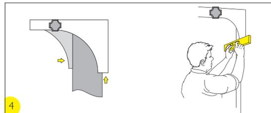
С помощью уровня убедитесь, что торцы всех четырех элементов свода лежат в одной плоскости, не смещены друг относительно друга и будут закреплены строго горизонтально.
