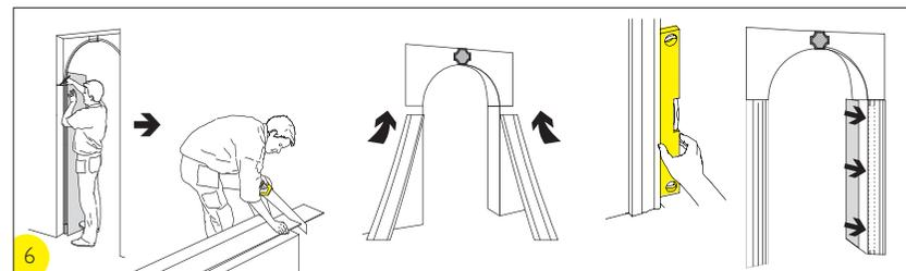
С помощью уровня убедитесь, что наличники будут закреплены строго вертикально. Предварительно нанеся столярный клей в пазы наличников установите в них вертикальные пластины. Закрепите наличники к проему при помощи монтажного клея или саморезов.
