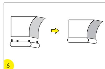
Измерьте расстояние между деталями сводами (толщина стены) и согласно полученному размеру отрежьте внутреннюю часть импоста. Прикрепите импост к деталям свода при помощи шкантов.
