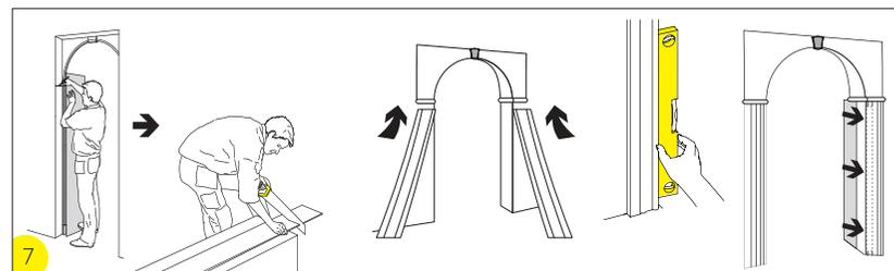
С помощью уровня убедитесь, что наличники будут закреплены строго вертикально. Предварительно нанеся столярный клей в пазы наличников установите в них вертикальные пластины. Закрепите наличники к проему при помощи монтажного клея или саморезов и к нижнему краю импоста при помощи шкантов.
